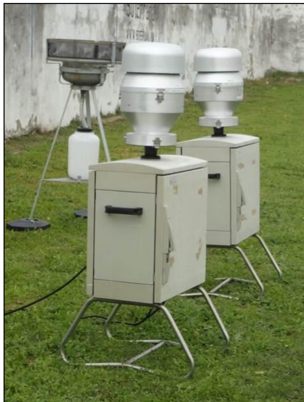
Figura 7- Equipos de toma de muestras de partículas atmosféricas y depósitos totales
