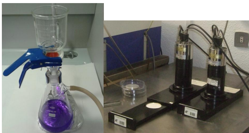
Figura 15- Filtración (método de coprecipitación) y detector de centelleo sólido
